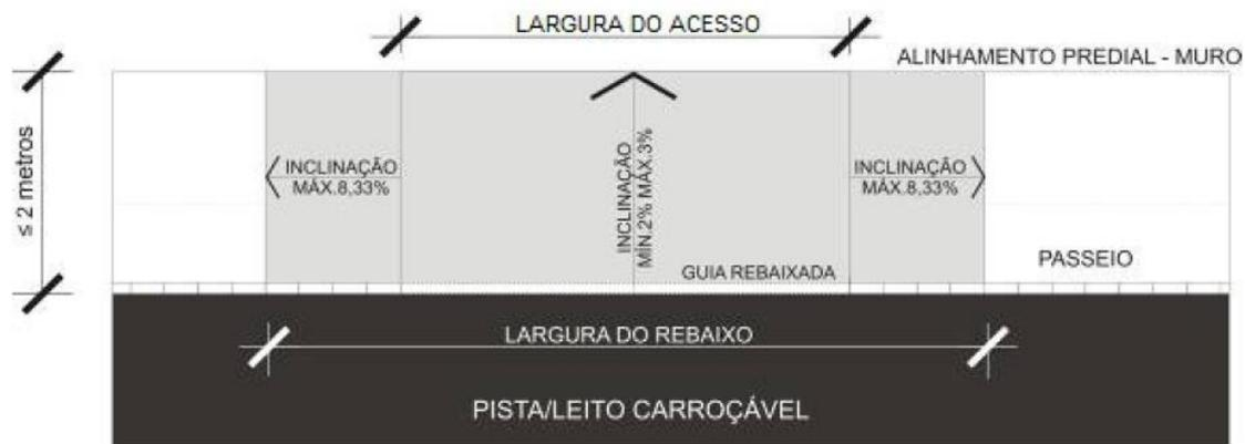
IMAGEM 5- Modelo de rampa exclusivo para rebaixo de veículos em calçadas com largura inferior a 2,00m.
