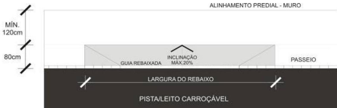
IMAGEM 4 – Modelo rampa exclusiva para rebaixo de veículos em calçadas com largura igual ou superior a 2,00m.
