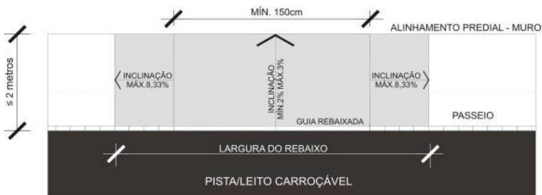
IMAGEM 3 – Rebaixamento padrão para pessoas com mobilidade reduzida – somente em calçadas com largura inferior a 3,00m.
