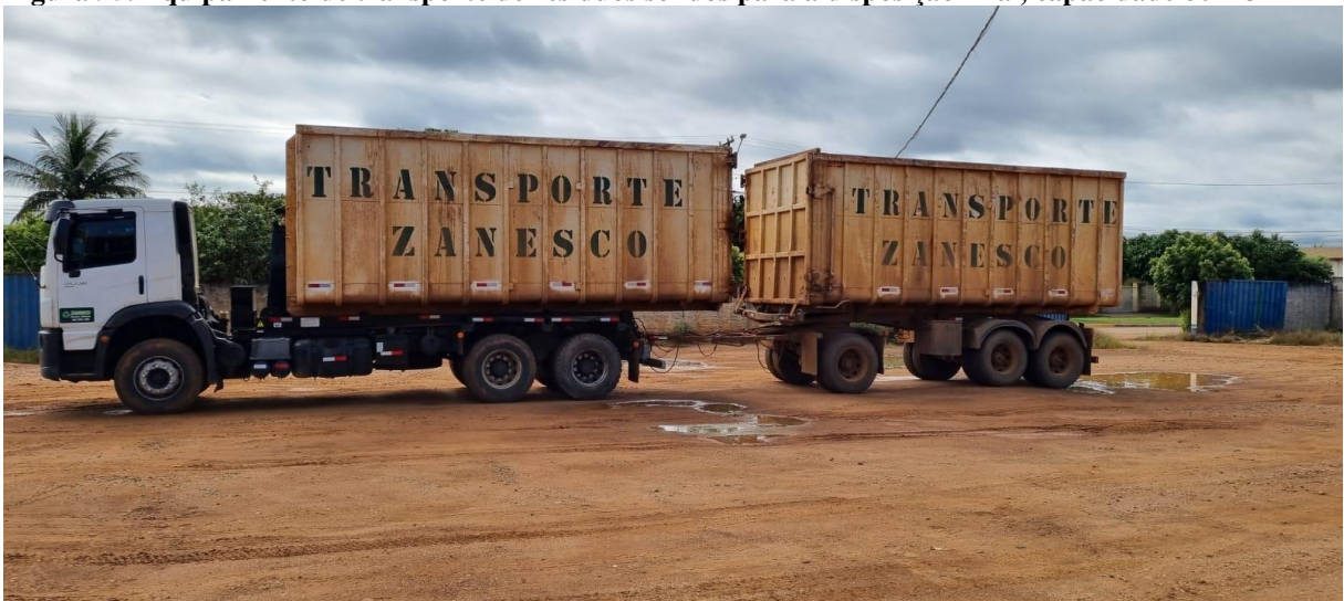
Figura 95. Equipamento de transporte de resíduos sólidos para a disposição final, capacidade 80 m3
