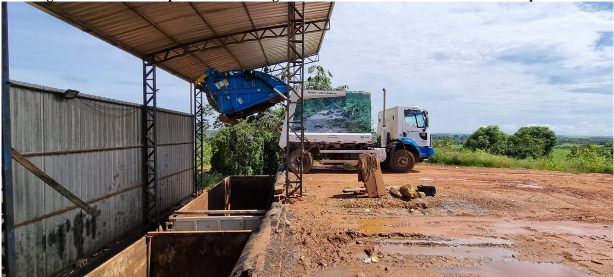
Figura 94. Veículo compactador descarregando os resíduos em containers de maior capacidade
