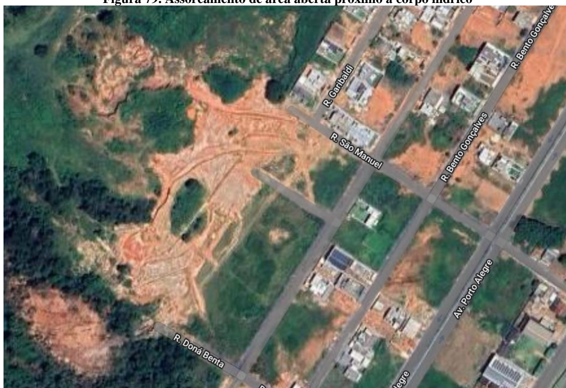
Figura 79. Assoreamento de área aberta próximo a corpo hídrico
