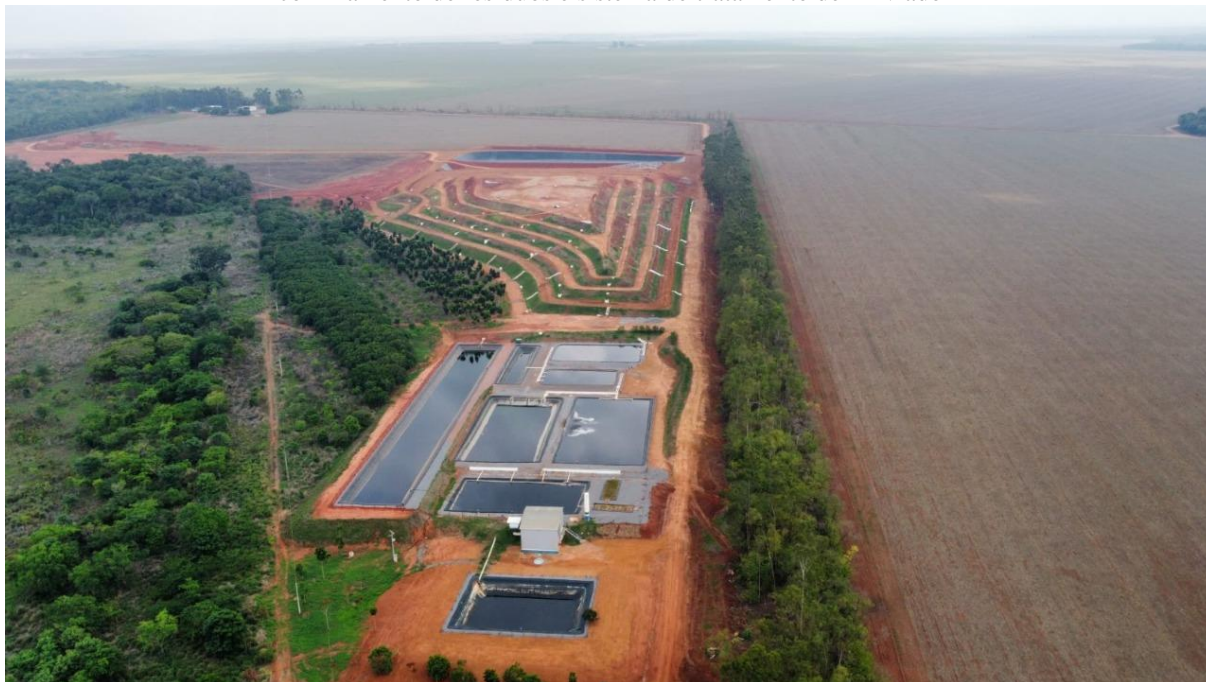
Figura 97. Imagem panorâmica da área do aterro sanitário da Sanorte-Unidade Sorriso, com vista do maciço de confinamento de resíduos e sistema de tratamento de lixiviado
