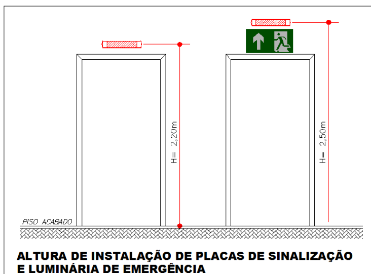
Figura 2 – Instalação das Luminárias de Emergência
