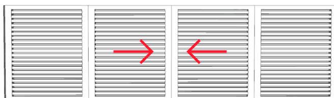
Figura 20 - Janela em vista (3,00x1,20m). Imagem ilustrativa
