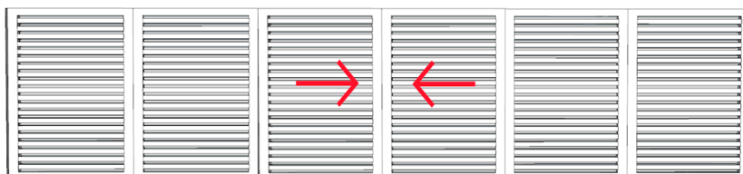
Figura 22 - Janela em vista (4,90x1,20m). Imagem ilustrativa
