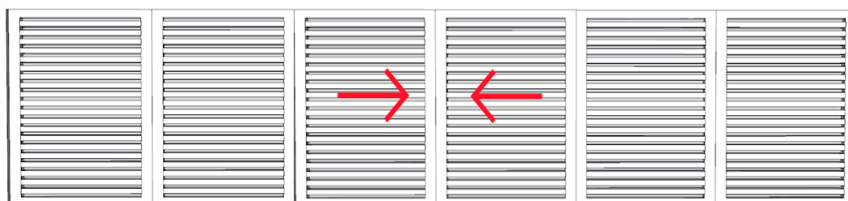
Figura 21 - Janela em vista (6,90x1,20m). Imagem ilustrativa
