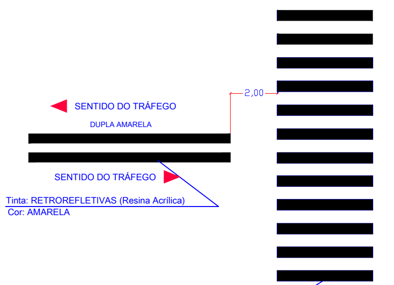
DETALHE H004 DETALHE DE SINALIZAÇÃO COMPLEMENTAR Tinta: RETROREFLETIVAS (Resina Acrílica) Cor: Branca
