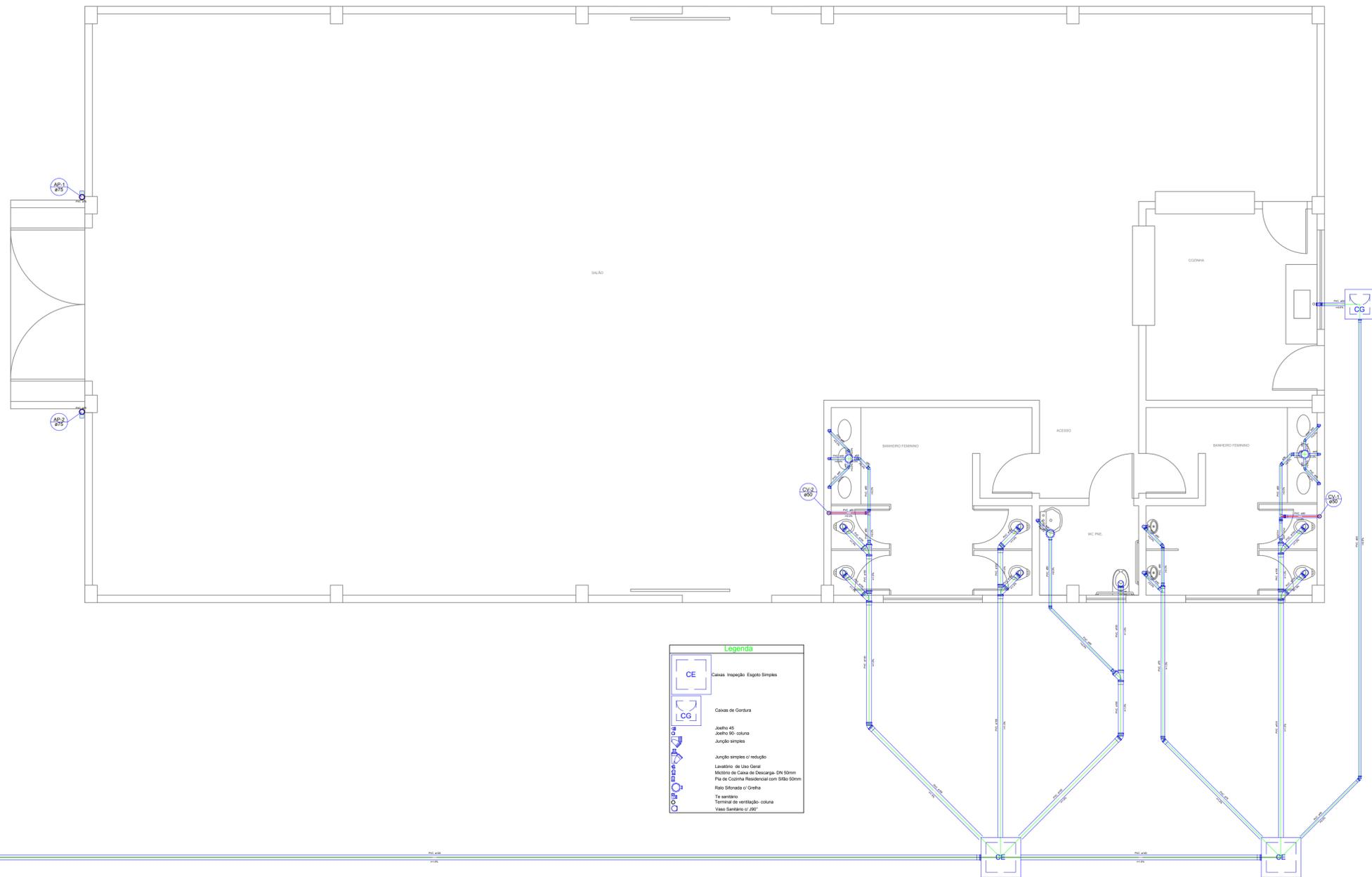
**PLANTA BAIXA - INSTALAÇÃO SANITÁRIA**
