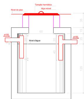
**CORTE - TANQUE SÉPTICO**
