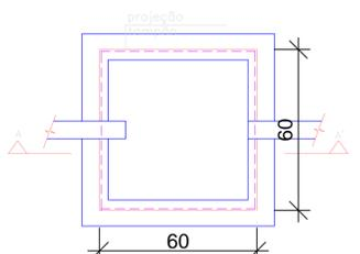
CAIXA DE INSPEÇÃO ESGOTO 60x60cm
