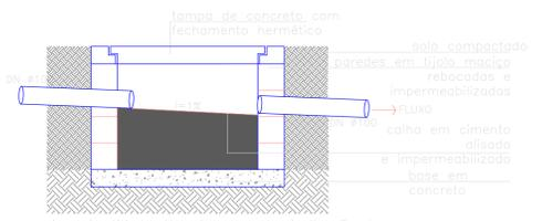
A profundidade da caixa segue a inclinação das tubulações
