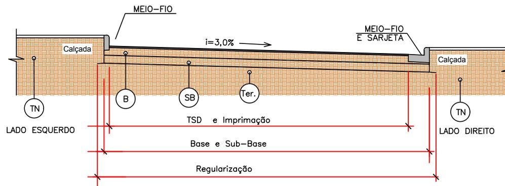
Det. Meio Fio com Sarjeta e Sem Sarjeta
