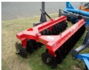
**ITEM 09:** Grade niveladora 14x28 para preparo do solo, com discos recortados na dianteira, feito com material de alta resistência.
