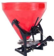
**ITEM 03** - Distribuidor de calcário mono disco 900 kg, com reservatório cônico, em polietileno virgem, estrutura em tubo curvado, fundo dosador em aço inox, com regulagem para direcionamento do fluxo de produto no disco.
