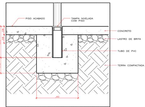
DETALHE 01 - SISTEMA DE FIXAÇÃO
